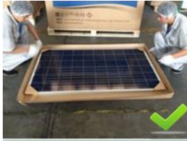
正确放置方式 接触地面
